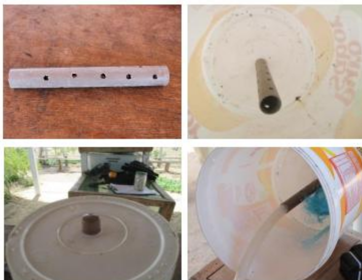
Figura 10: Biofiltro com destaque para furos no fundo do balde e conexão com mangueira. Fonte: EMBRAPA.
